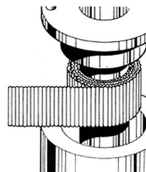
Fitas de Grafite Flexível recartilhada para engaxetamento de haste de válvula, eixos de bombas e outros equipamentos.
