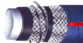
Descrição Técnica: Tubo interno: PLC/TFE de altíssima densidade, preto, acabamento liso. Reforço: Têxtil sintético, trançado. Espiral: Em aço, embutido. Cobertura: resistente à produtos químicos e ao tempo, (preta, c/ textura).
