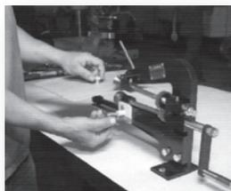
3. Gire a manivela e corte o diâmetro externo da junta
