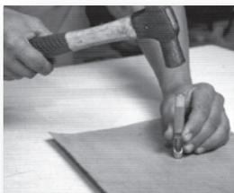
2. Regule o cortador para o corte do diâmetro externo da junta
