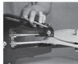
4. Regule o cortador para o corte do diâmetro interno da junta
